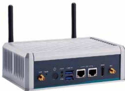
Jetson TX2 представляет собой процессорный модуль, несущий чип с ARM-совместимыми процессорами Denver2 (2 ядра) и Cortex-A57 (4 ядра), а также графический контроллер семейства Pascal с 256 вычислительными ядрами. Помимо основного чипа на модуле находятся также: чипы оперативной памяти (8 ГБ LPDDR), накопитель eMMC, контроллер беспроводной связи.
