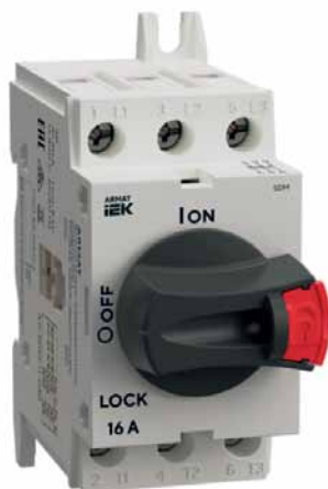
Рис. 1. Выключатель-разъединитель SDM для установки на DIN-рейку: серия ARMAT включает аппараты на номинальные токи от 16 до 125 А с категориями применения AC-21A/B, AC-22A/B и AC-23A/B
