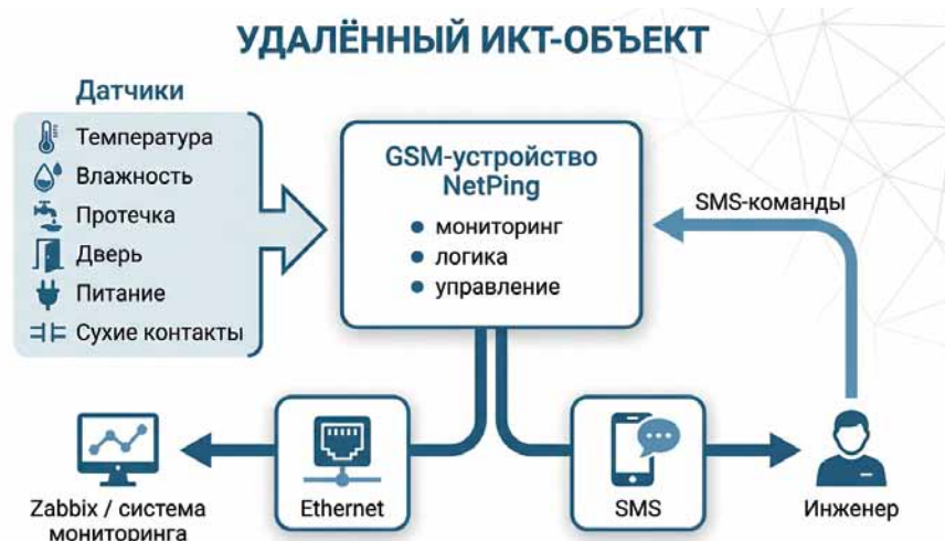
Рис. 1. Схема мониторинга удаленного ИКТ-объекта с GSM-каналом
