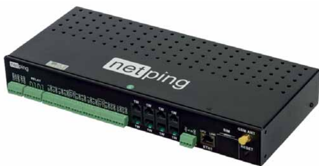
Рис. 2. Контроллер NetPing server solution v7/GSM
