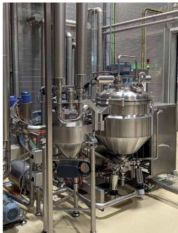
Рис. 3. «Вибровилки» ОВЕН решают задачи контроля уровня вязких и липких сред на масложировых производствах
