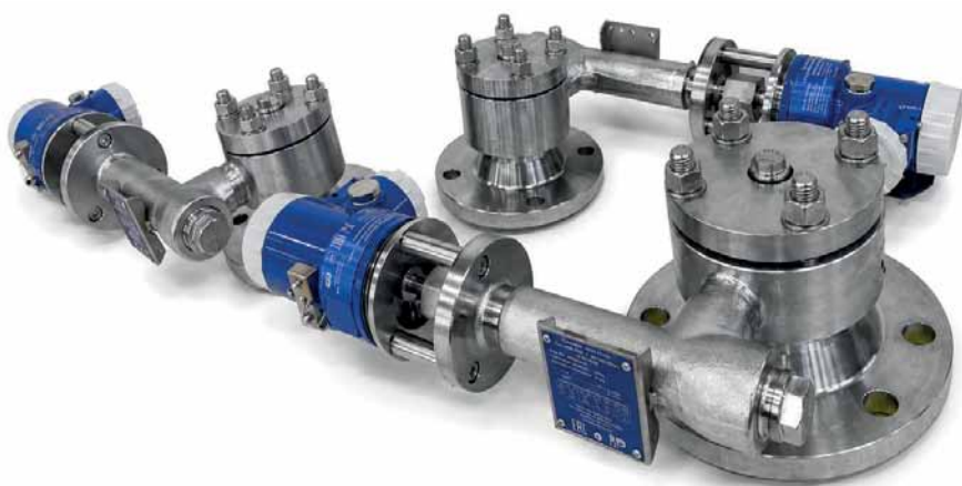
Рис. 2. Датчик уровня LLT-DS с выносной измерительной камерой и опускаемыми трубами для гашения турбулентности
