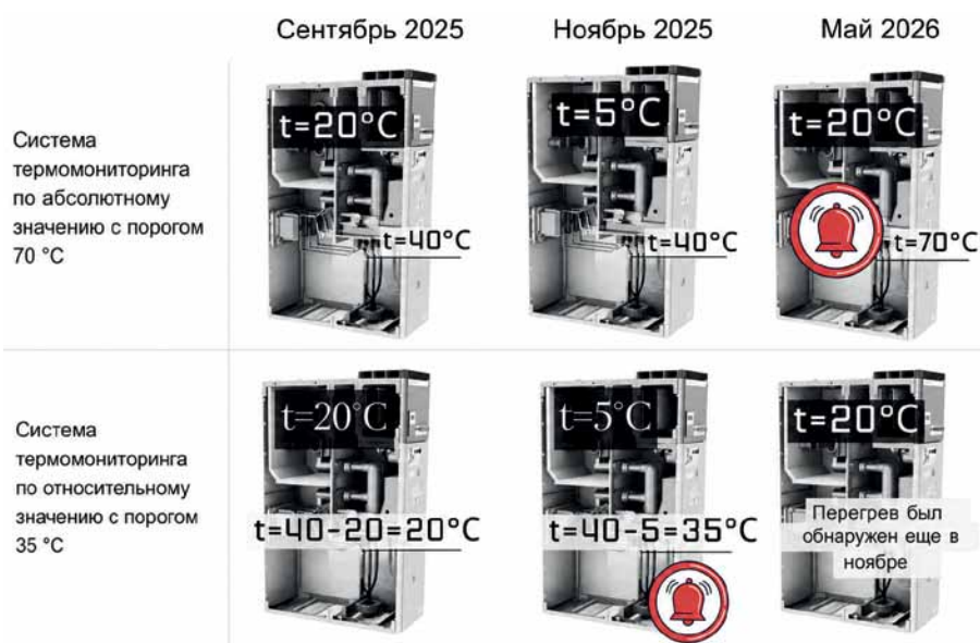
Рис. 5. Алгоритм детектирования по относительному значению позволяет обнаружить перегрев на полгода раньше, чем детектирование по абсолютному значению
