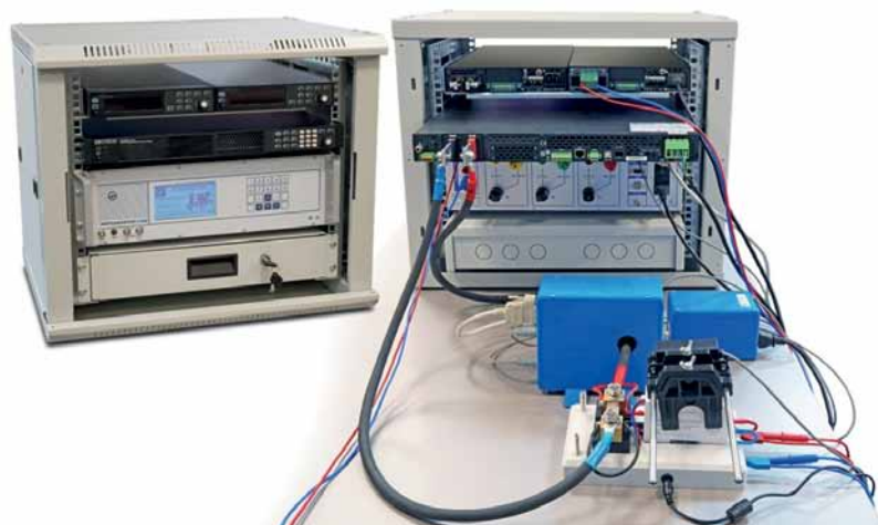
Рис. 6. Подключение счетчика постоянного тока с шунтом к установке УППУ-МЭ-DC
