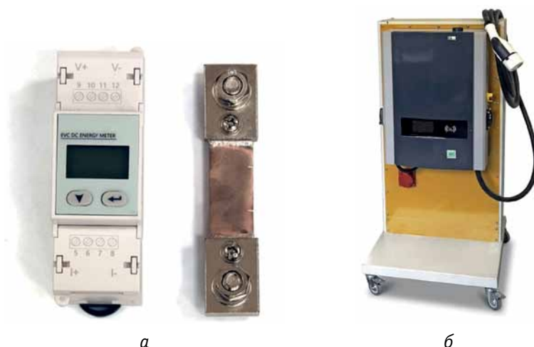
Рис. 1. Объекты поверки: а — счетчик электроэнергии с измерительным преобразователем тока (шунтом); б — зарядная станция со встроенным измерительным модулем или счетчиком электроэнергии
