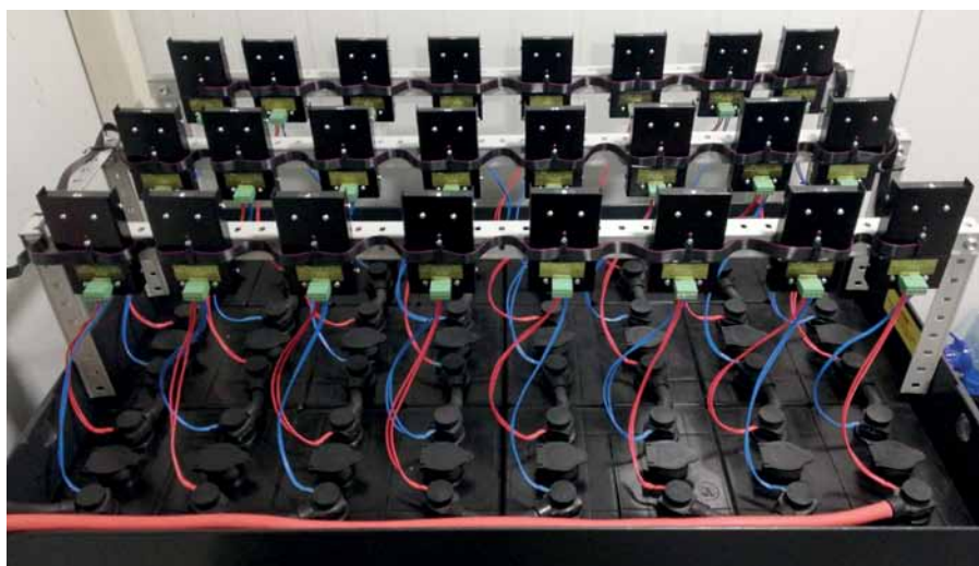
Рис. 3. Балансировка промышленной высоковольтной сборки
