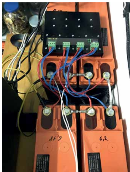
Рис. 2. Обслуживание АКБ с помощью балансира
