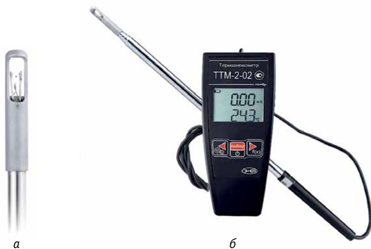
Рис. 3. Термоанемометр ТТМ-2: а – первичный преобразователь; б – портативное исполнение прибора (модель ТТМ-2-02)
