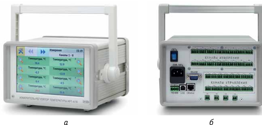
Рис. 4. Измеритель-регулятор ИРТ-4/16-Т: а – сенсорный дисплей; б – каналы измерения и управления
