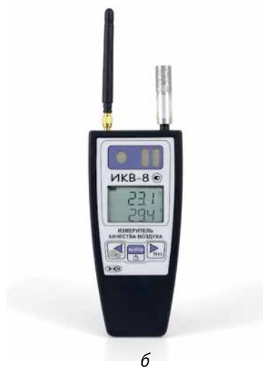
Рис. 5. Измерители качества воздуха ИКВ-8: а – стационарный ИКВ-8-Н; б – портативный ИКВ-8-П
