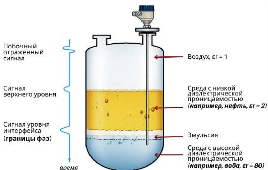
Рис. 1. Принцип работы волноводно-радарного уровнемера с направляемой волной MicroTREK HT-700
