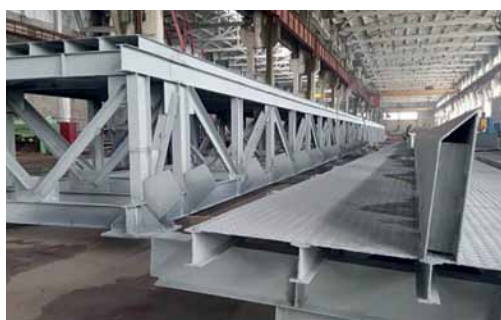
Рис. 1. Примеры объектов, на которых применялось цинкирование составом класса Zinker: а – купольные фермы; б – конструкции моста; в – дорожные отбойники
