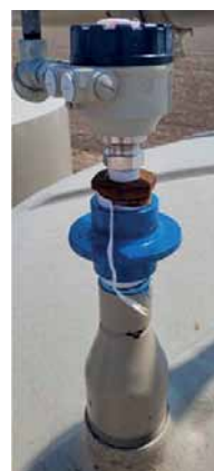
Рис. 4. Монтаж MicroTREK HT-700 на металлический фланец: а – схема и размеры соединения; б – внешний вид
