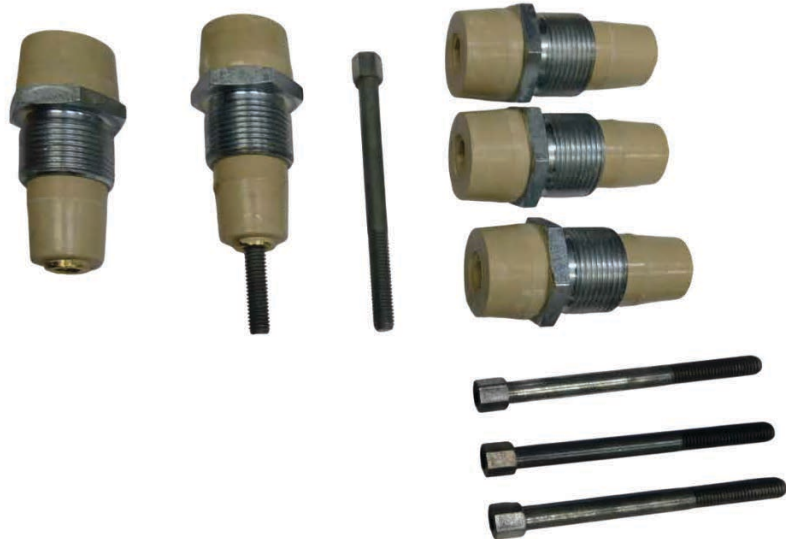
Рис. 3. Основные элементы опорного изолятора: изоляционная оболочка из премикса ДМС-20-РМ с запрессованной гайкой и токоведущие стержни с наружной резьбой
