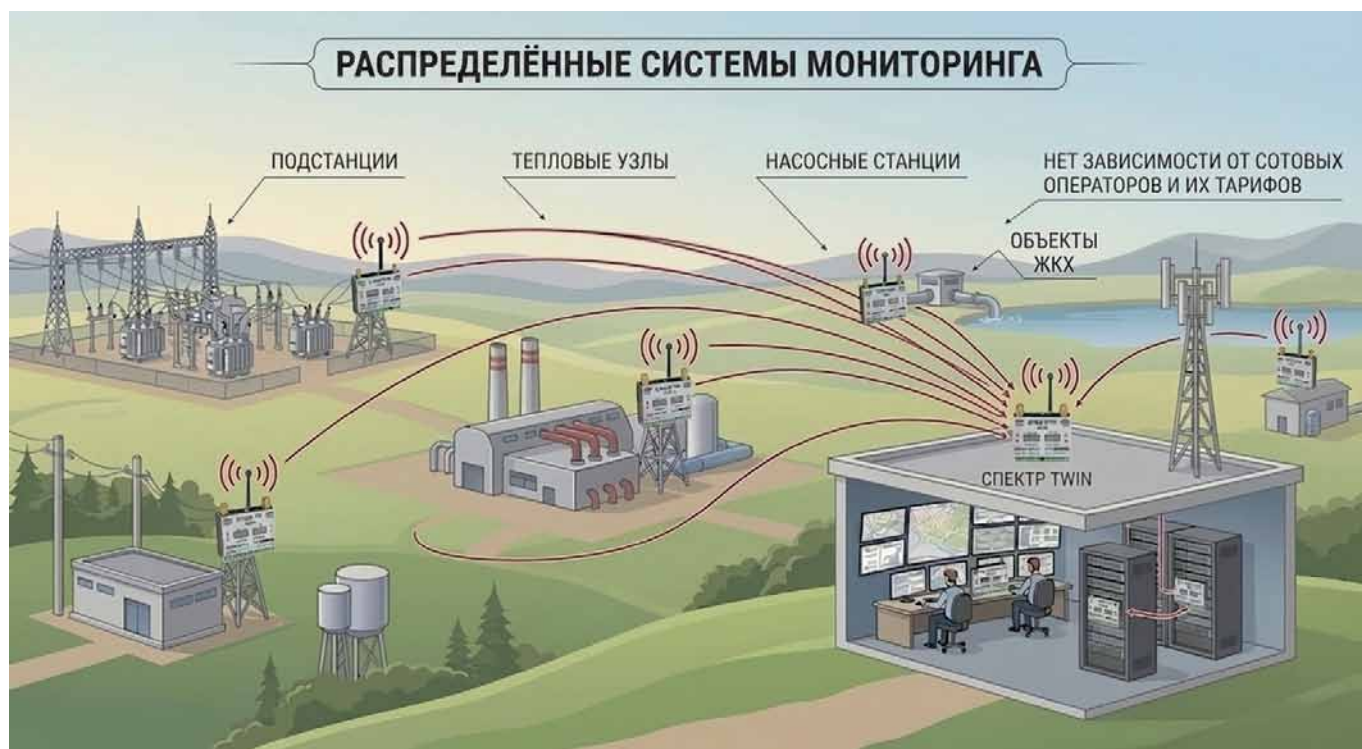
Рис. 3. Построение распределенной системы мониторинга на базе «Спектр TWIN»
