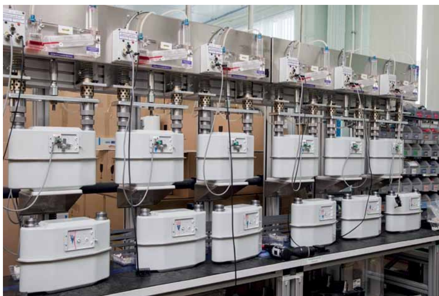
Рис. 3. Поверка и калибровка счетчиков газа ВК на заводе «РАСКО Газэлектроника» (г. Арзамас)
