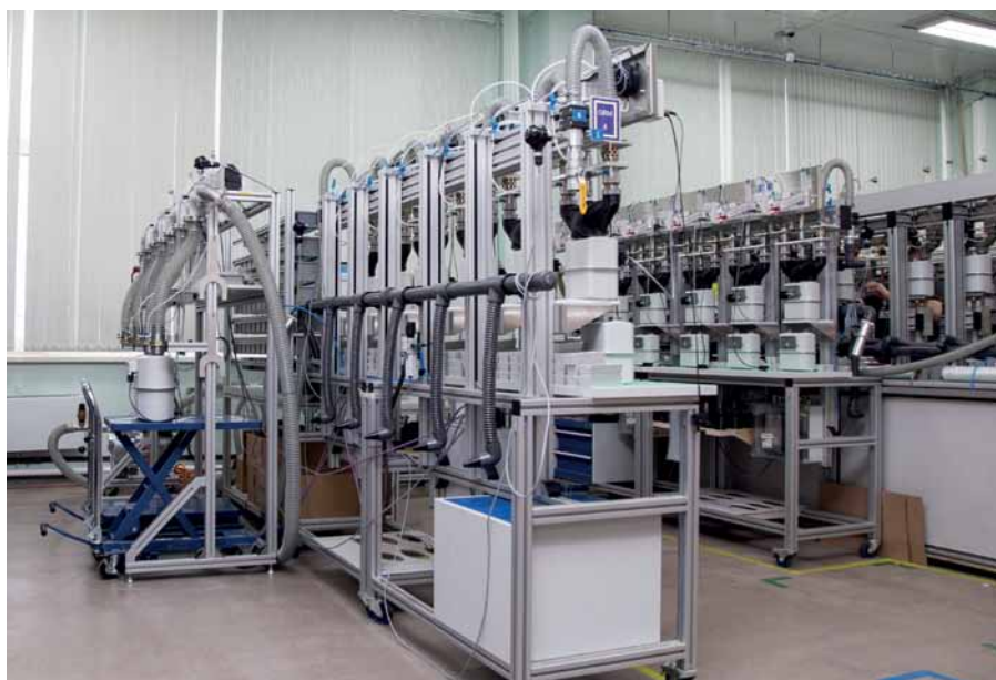
Рис. 2. Процесс поверки диафрагменных счетчиков газа ВК на заводе «РАСКО Газэлектроника» (г. Арзамас)
