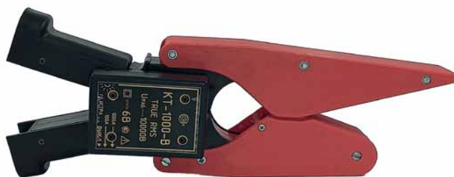
Рис. 1. Внешний вид серийных токовых клещей КТ-1000-В с конструктивной доработкой губок для захвата фазного провода
