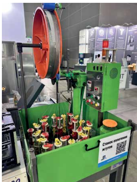
Рис. 6. Станок для оплетения жгутов на выставке ExpoElectronica 2024
