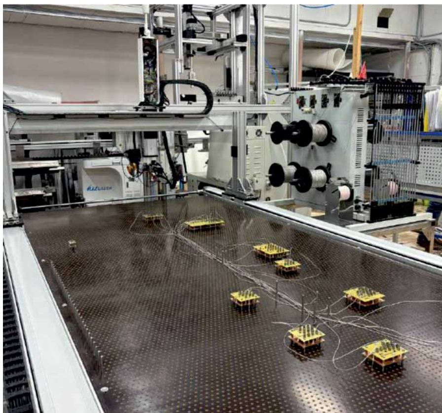
Рис. 1. Станок ЧПУ раскладывает провода на плазе
