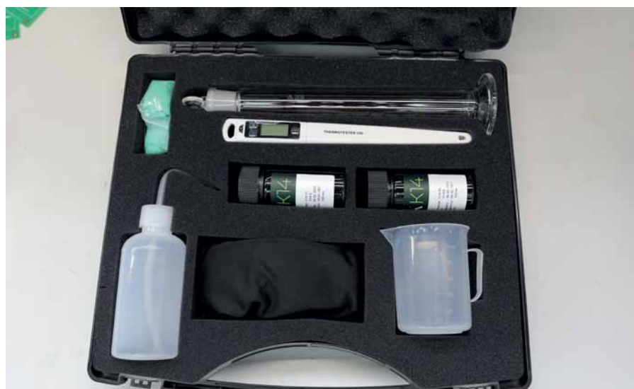
Рис. 1. Тестовый набор Гидронол К14 для контроля состояния растворов щелочных отмывочных жидкостей Гидронол
