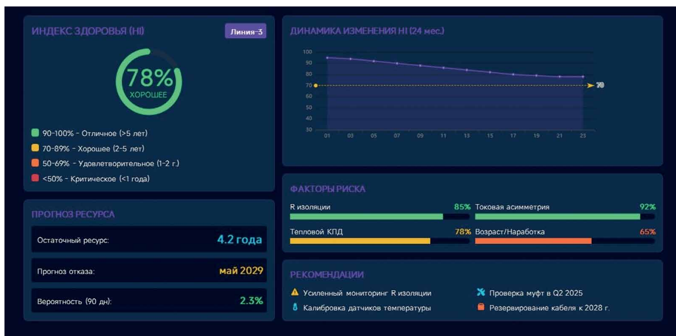
Рис. 1. Система «Квант»: определение остаточного ресурса и прогнозирование отказов
