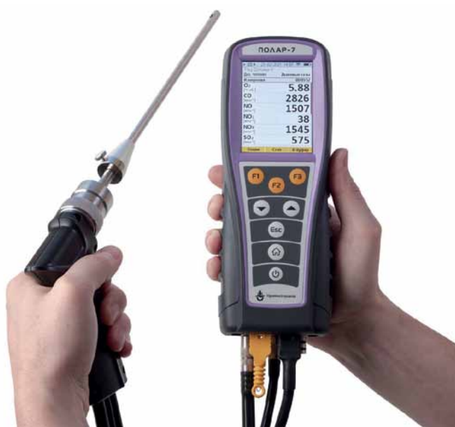
Рис. 1. Переносной многокомпонентный газоанализатор «Полар-7»: а – с зондом температуры воздуха; б – прикрепленный к металлической поверхности с помощью магнитов
