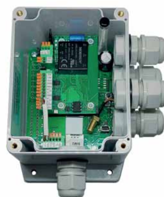
Рис. 4. Регистратор гидроударов серии PROMODEM PRO с автономным или внешним питанием
