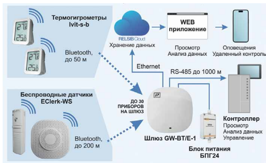
Рис. 3. Преобразователь интерфейсов GW-BT/E-1 в системе мониторинга и автоматизации
