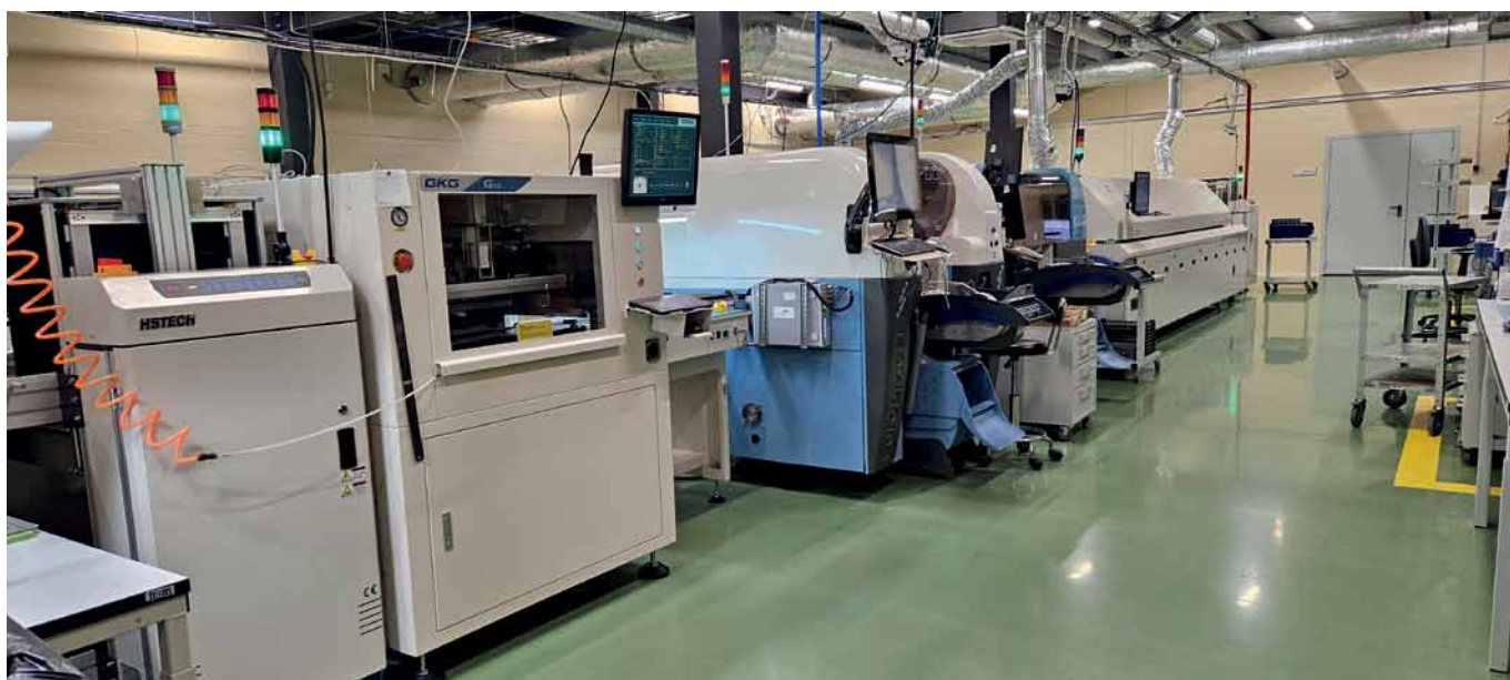
Рис. 2. Производственная линия SMT-монтажа ООО «МЕАНДР»
