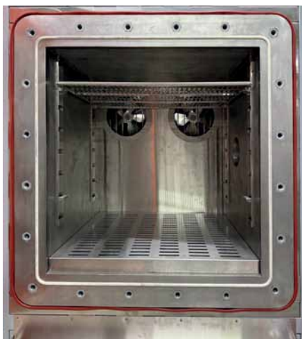
Рис. 2. Рабочий объем термобарокамеры «ТЕХНОЛОГИЯ»
