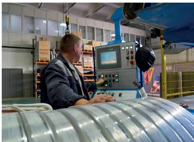
Рис. 3. Производство трансформатора: процесс намотки катушки ВН из алюминиевой ленты
