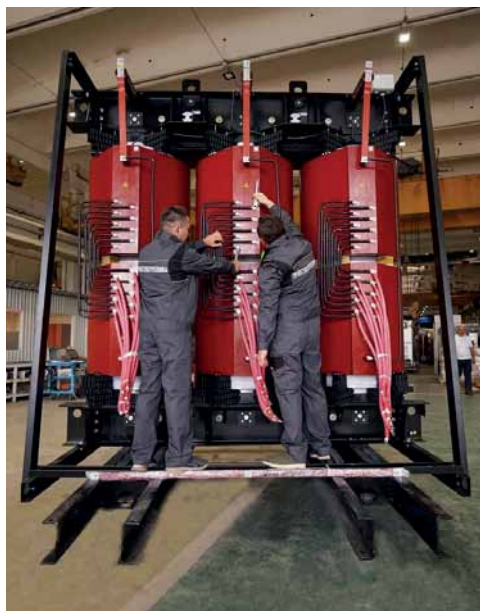
Рис. 1. Сухой трансформатор с литой изоляцией ООО «Проектэлектротехника»: 4-й габарит, мощность 10 МВА, напряжение 35/10 кВ
