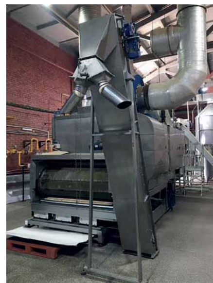
Рис. 2. Конвейерная печь для обжарки орехов
