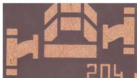
Рис. 5. Керамическая подложка полупроводникового кристалла под видеомикроскопом
