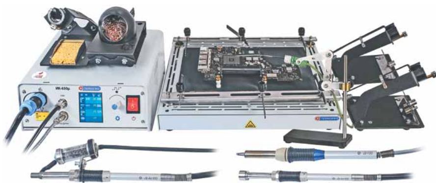
Рис. 3. Термовоздушная паяльная станция ИК-650 micro
