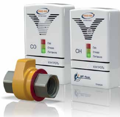
Рис. 1. Основные элементы бытовой системы контроля загазованности САКЗ-МК®-2Ai
