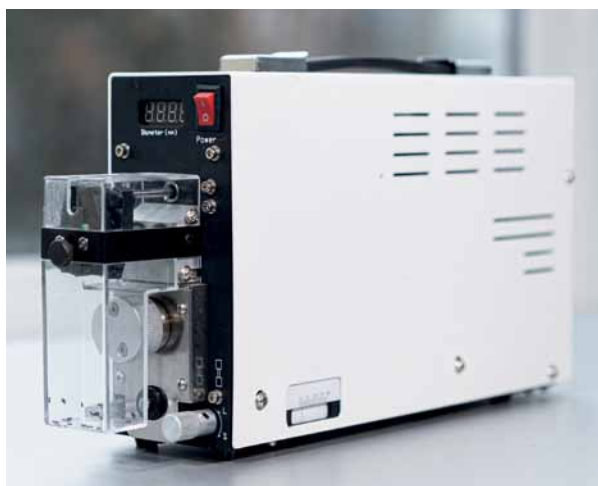
Рис. 3. Станки для зачистки проводов
