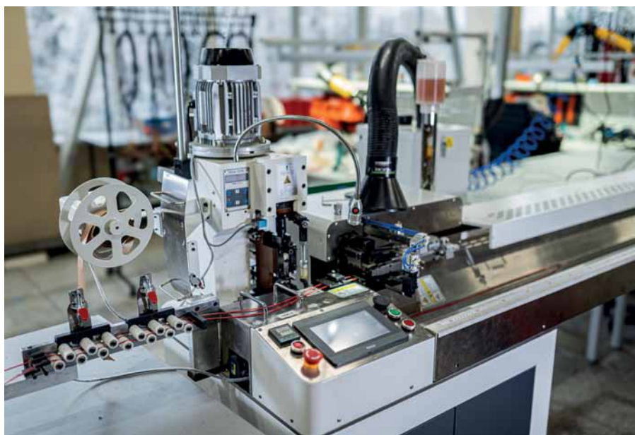
Рис. 1. Линия автоматической нарезки и обжима провода
