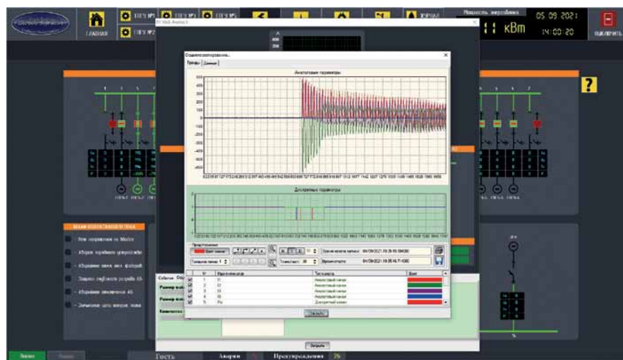
Рис. 2. SCADA TechnoSoft: окно работы с осциллограммами
