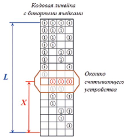
Рис. 3. Схема устройства оптического датчика
