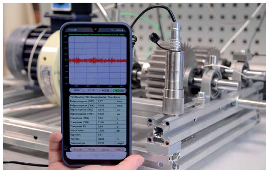
Рис. 1. Портативная система виброанализа подшипников ZETLABVibroMetr mod. 117B
