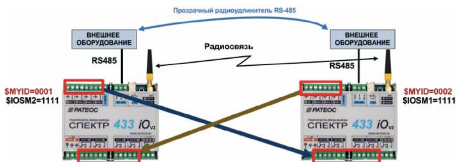
Рис. 4. Одновременная передача данных по RS-485 и трансляция входов между двумя радиомодулями
