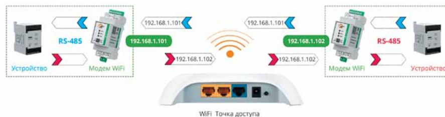
Рис. 7. Радиодлинитель «точка – точка» RS-485 – RS-485, реализованный с помощью двух Wi-Fi-конвертеров RS-485 PROMODEM WiFi (представлен вариант с внешней точкой доступа, можно и без нее)
