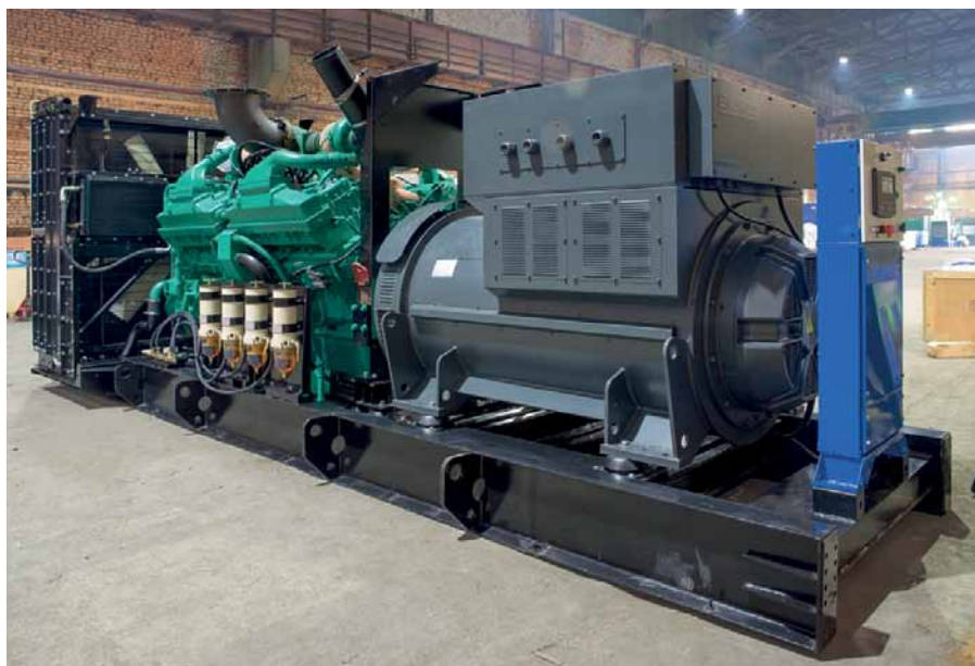
Рис 2. Дизель-электростанция с двигателем QSK60-G8 и генератором Evotec в сборе
