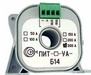
Рис. 3. Датчик тока ПИТ-xxx-УА-Б14 для измерения тока до 300 А, с диаметром отверстия под токовую шину 14 мм и возможностью крепления в блок с помощью DIN-рейки
