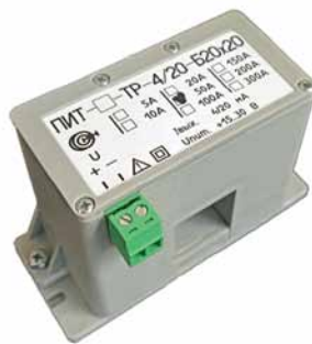
Рис. 5. Разъемные датчики тока, которые не требуют демонтажа токовой цепи и крепятся непосредственно на токовой шине: а – ПИТ-xxx-ТР-4/20-Б20x20 с отверстием под токовую шину 20 × 20 мм и диапазоном измерения тока 300 А; б – ПИТ-xxx-ТР-4/20-Б50-М для крепежа на шине диаметром до 50 мм, диапазон измерения 1000 А
