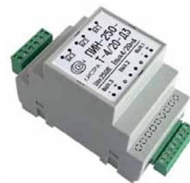
Рис. 7. Датчик ПИН-xxx-Т-4/20-ДЗ для измерения 3-фазного напряжения до 400 В; True-RMS и возможность крепежа на DIN-рейку
