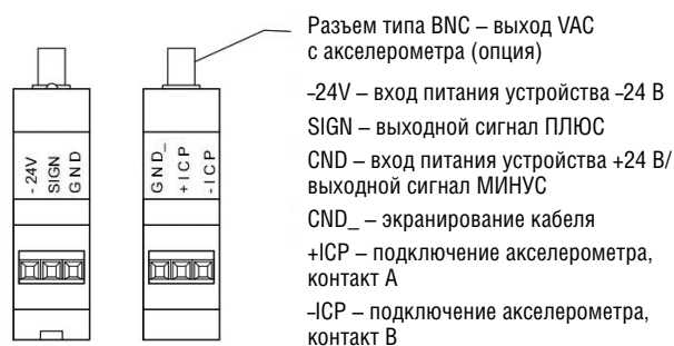
Рис. 3. Назначение контактов преобразователя ВТК-2-010BN-DIN
