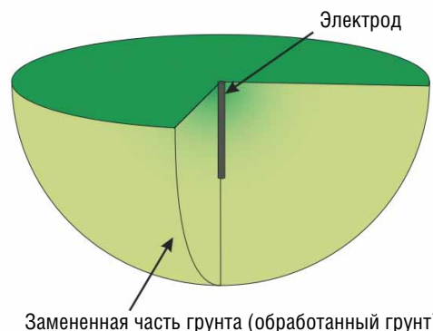
Рис. 1. Электрод в почве с заменой части грунта на засыпку с низким УЭС или в грунте с химической обработкой
