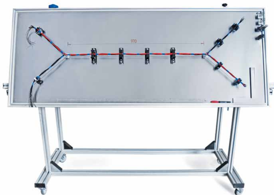
Рис. 1. Сборочный плаз с магнитными держателями
