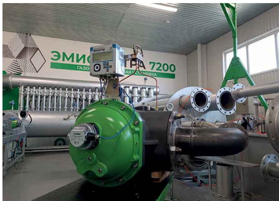
Рис. 4. Комплекс учета газа «ЭМИС-Эско 2230» на базе ротационного счетчика «ЭМИС-РГС 245» типоразмера G 1000 (Ду 200)
