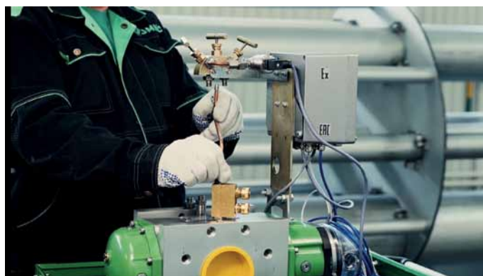
Рис. 2. Сборка комплекса учета газа «ЭМИС-Эско 2230»
