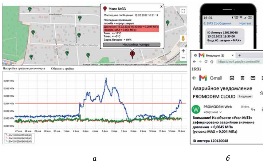
Рис. 3. Извещение в случае аварийных событий: а – индикация на веб-карте системы диспетчеризации PROMODEM CLOUD; б – аварийные сообщения, разосланные по e-mail и СМС на телефоны сотрудников
