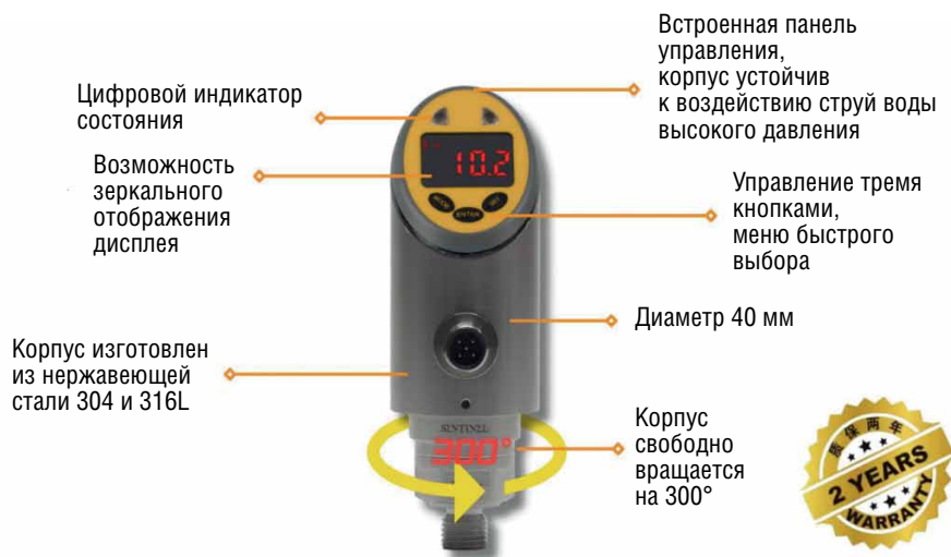
Рис. 5. Датчики давления серии SE: внешний вид и основные конструктивные характеристики
