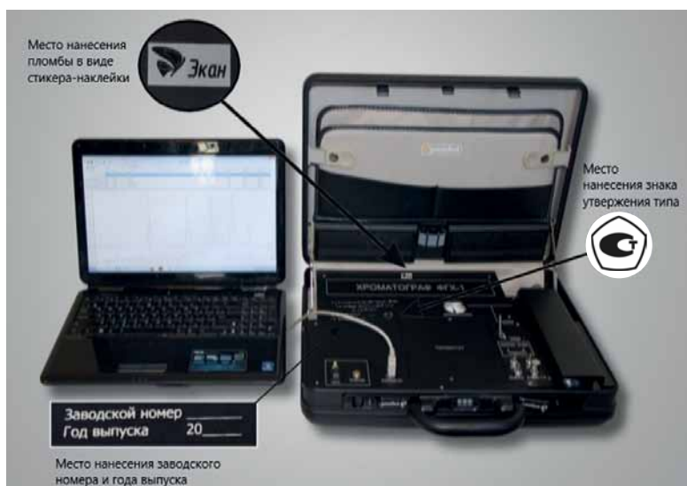
Рис. 1. Общий вид хроматографа газового портативного ФГХ: переносной вариант
