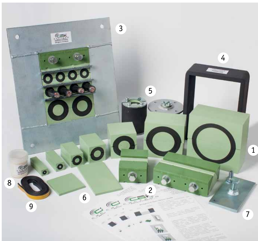
Рис. 1. Компоненты системы ввода кабеля: 1 – проходки квадратного сечения; 2 – блоки монтажные; 3 – рамка с фланцем (вариант в сборе); 4 – рамка без фланца (приварная); 5 – проходки круглого сечения с гильзами; 6 – модули прямоугольного сечения; 7 – прижимное устройство; 8 – смазка жировая; 9 – лента уплотнительная
