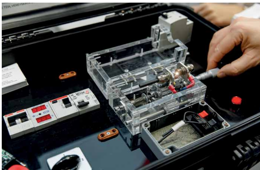
Рис. 3. Демонстрация работы АВ, ВДТ и УЗДП на стенде при дуговом пробое
