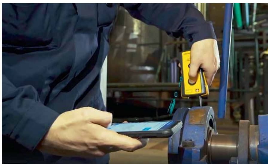
Рис. 5. Работа мобильного устройства АВ5 в составе АИС «Мобильный обходчик» на базе платформы «СИГМА: Алькор»
