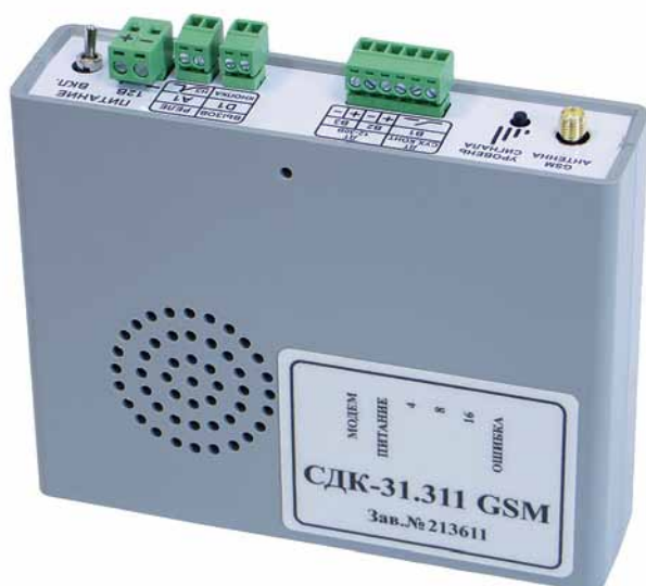
Рис. 3. Блок контроля СДК-311 GSM для диспетчеризации подъемных платформ для маломобильных групп населения
