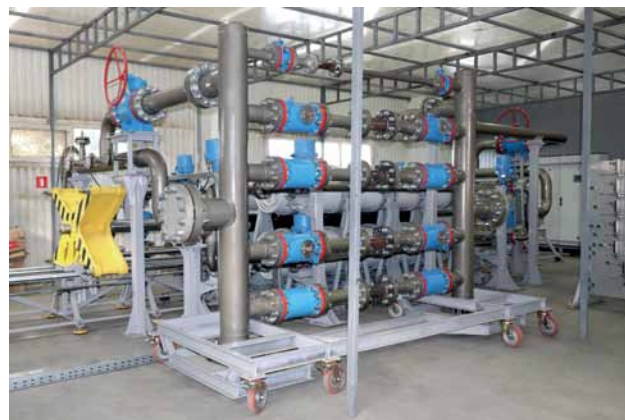
Рис. 2. Государственный первичный эталон единицы объемного расхода природного газа при давлении до 10 МПа
