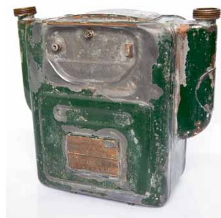
Рис. 2. Диафрагменный счетчик газа фирмы Kromschroder 1941 года выпуска
