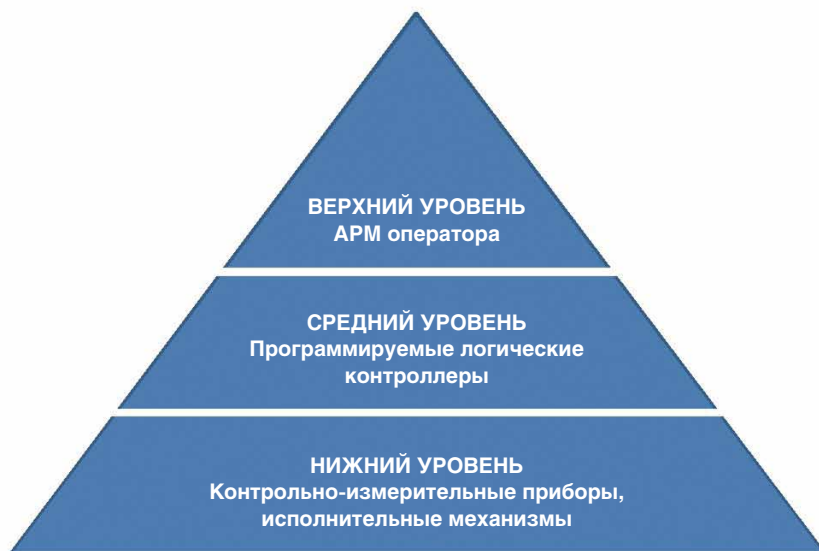
Рис. 1. Иерархическая трехуровневая структура АСУ ТП с классической архитектурой
