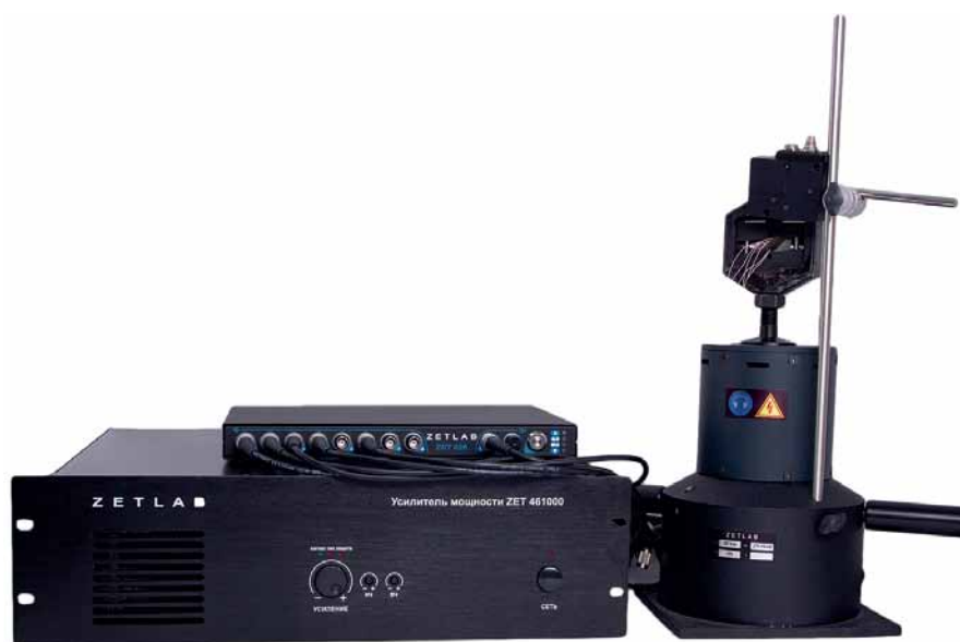
Рис. 1. Вибрационная установка для усталостных испытаний лопаток ГТД
