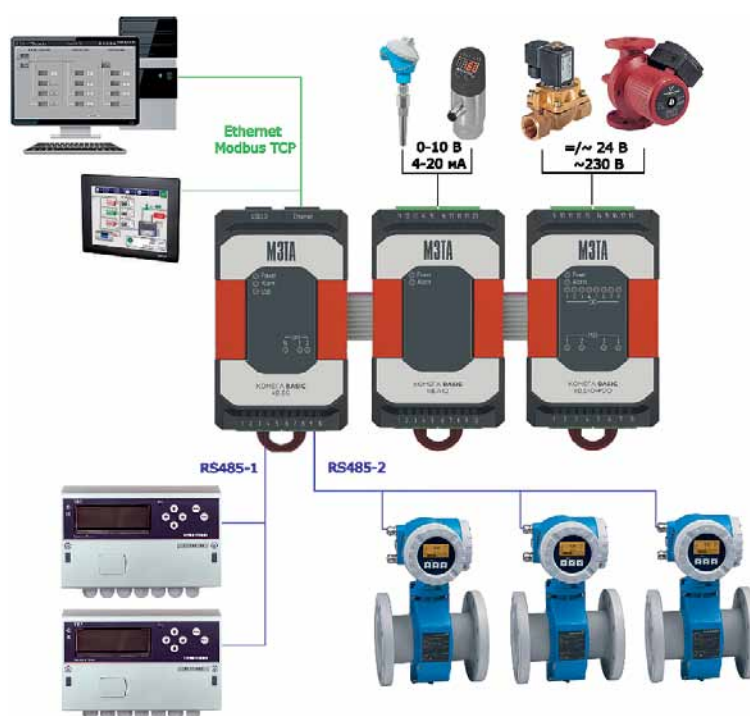
Рис. 2. Подключение датчиков и исполнительных механизмов к шлюзу kV.EG и модулям расширения «КОМЕГА Basic»
