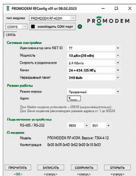
Рис. 4. Пример настройки радиомодема PROMODEM RF-433
