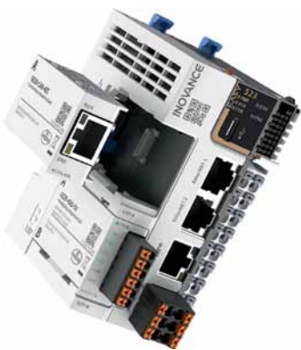
Рис. 2. Контроллер серии EASY: пример набора интерфейсов связи
