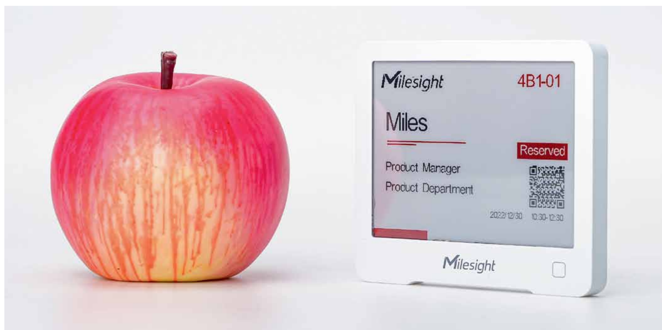
Рис. 1. Дисплей на электронных чернилах Milesight E-ink Display
